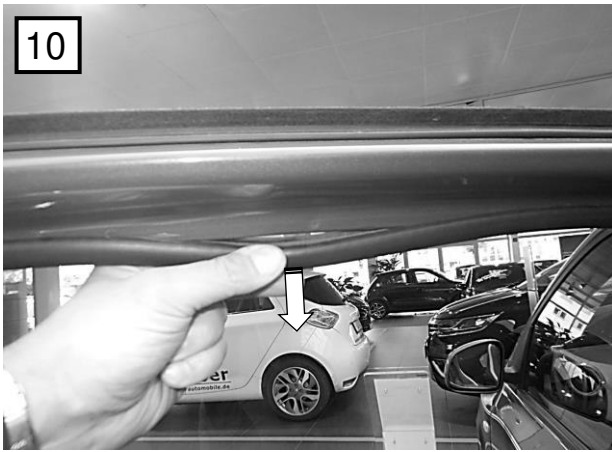
10 Fenstergummi abziehen / remove the window rubber
