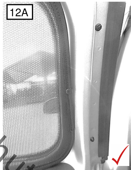
11 Der Halter wird unter dem Gummi auf das Blech gesteckt / The holder is under the rubber put on the sheet metal
